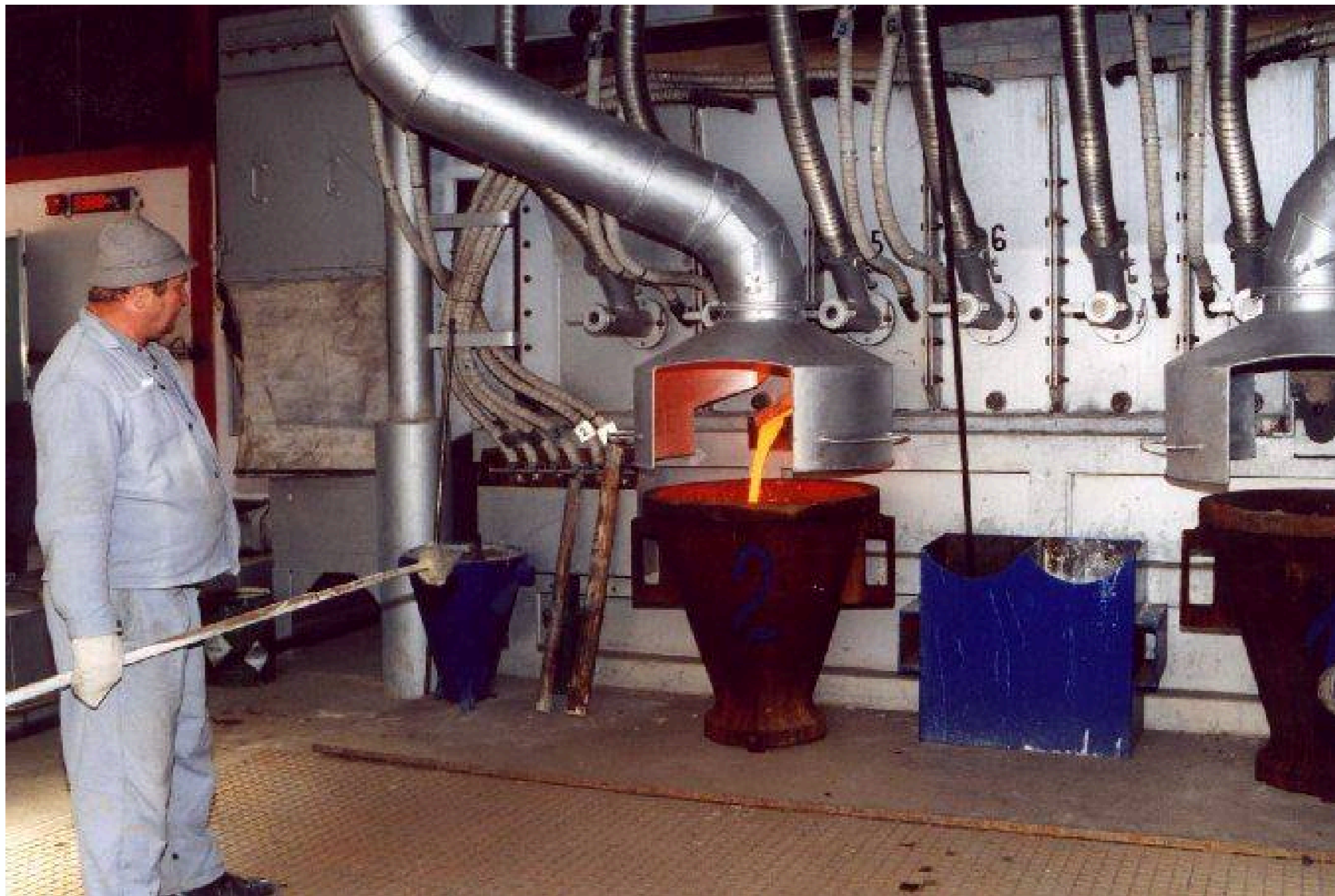
Zahájení provozu nové šachtové pece - odpich strusky
