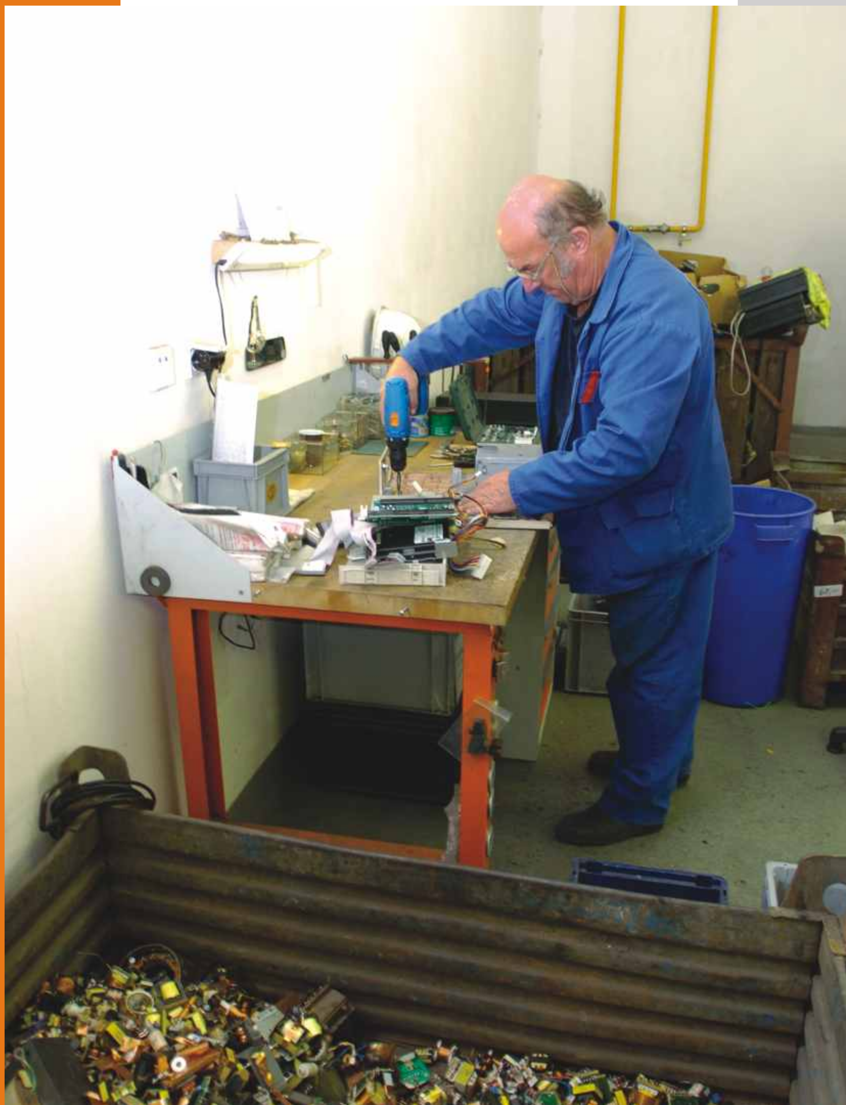
„Ruční rozebírání vyřazených elektrozařízení v divizi Elektroodpad“
